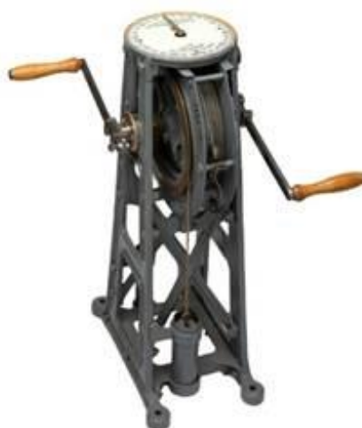
Ryc.5. Maszyna sondująca Kelvina, Kelvin Sounding Machine (źródło: Royal Museums Greenwich)
